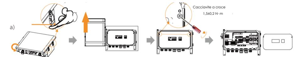
b) Mettere il Matebox sul supporto. Assicurarsi che il dispositivo sia ben fissato sul supporto avvitando saldamente tutti i dadi.
